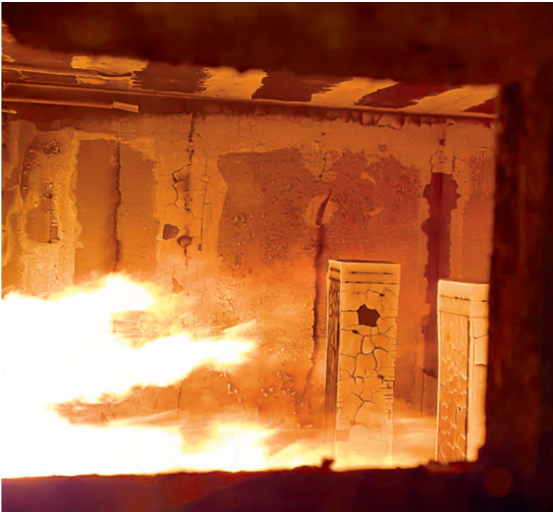
Brandprüfung mit Flamtex A1
